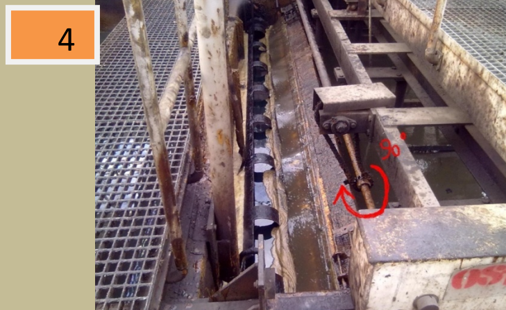
شکل ۱۲. انتقال مواد توسط حرکت ۹۰ درجه ای پارویی
